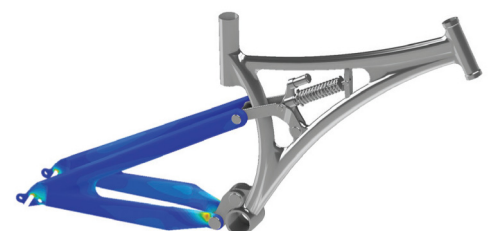
Resultados del esfuerzo equivalente en el cuadro de una bicicleta de montaña
